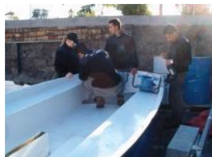
Montaje de los herrajes en un "caravelle".
