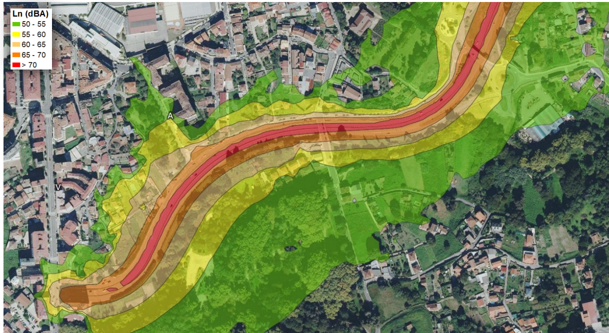
Figura 7. Niveis de ruído nocturno, L_n (dBA), debidos á Avenida Arquitecto Palacios
