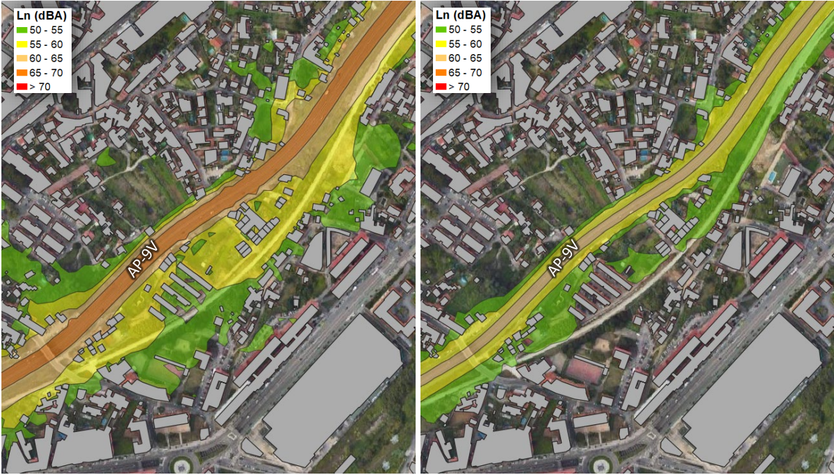
Figura 40. Niveis de ruído nocturno, Ln (dBA), nunha contorna da AP-9V. Esquerda, situación actual; dereita, tras unha hipotética redución de velocidade
