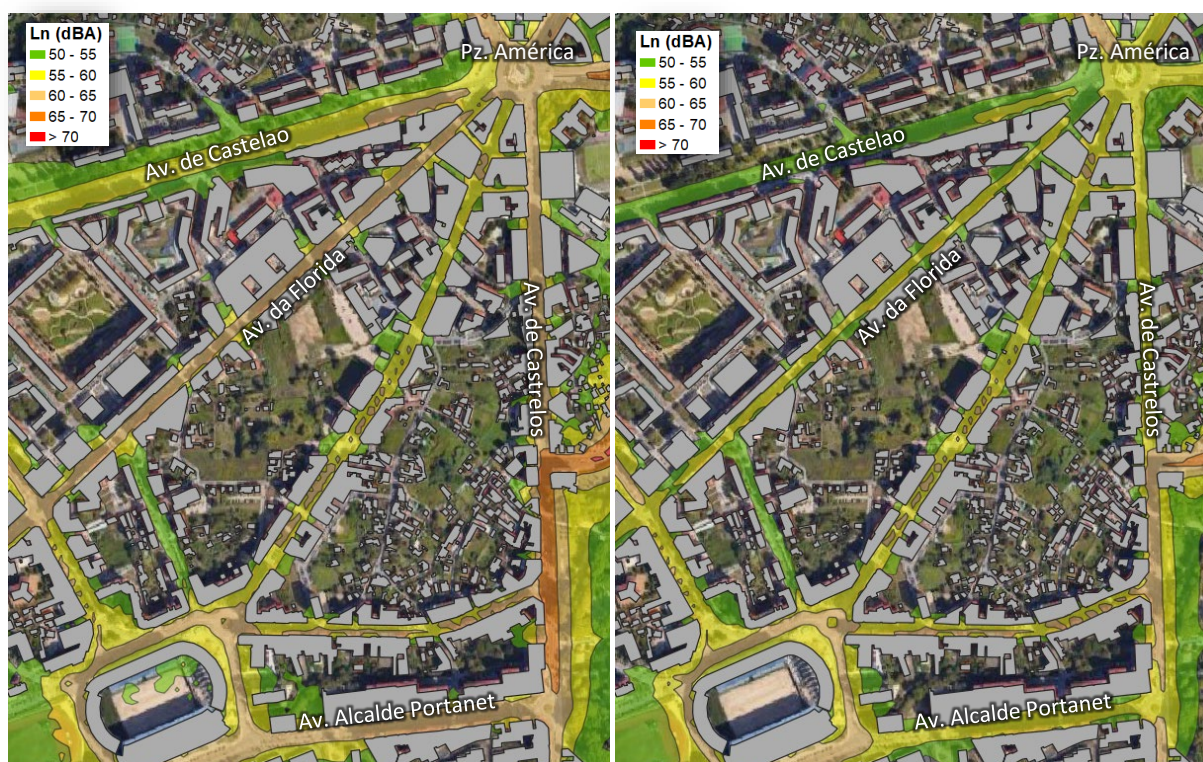
Figura 32. Niveis de ruído nocturno, Ln (dBA), na contorna da Avenida de Castelao, Castrelos, Florida e Alcalde Portanet. Esquerda, situación actual; dereita, tras o asfaltado acústico indicado
