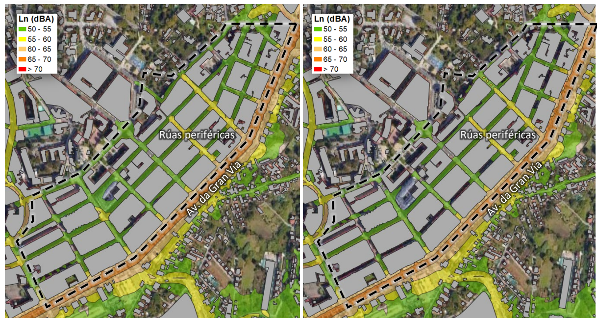
Figura 24. Niveis de ruído nocturno, Ln (dBA), na contorna de Gran Vía entre Praza España e Praza América, e as súas rúas periféricas. Esquerda, situación actual; dereita, tras o asfaltado acústico e a redución de velocidade indicada
