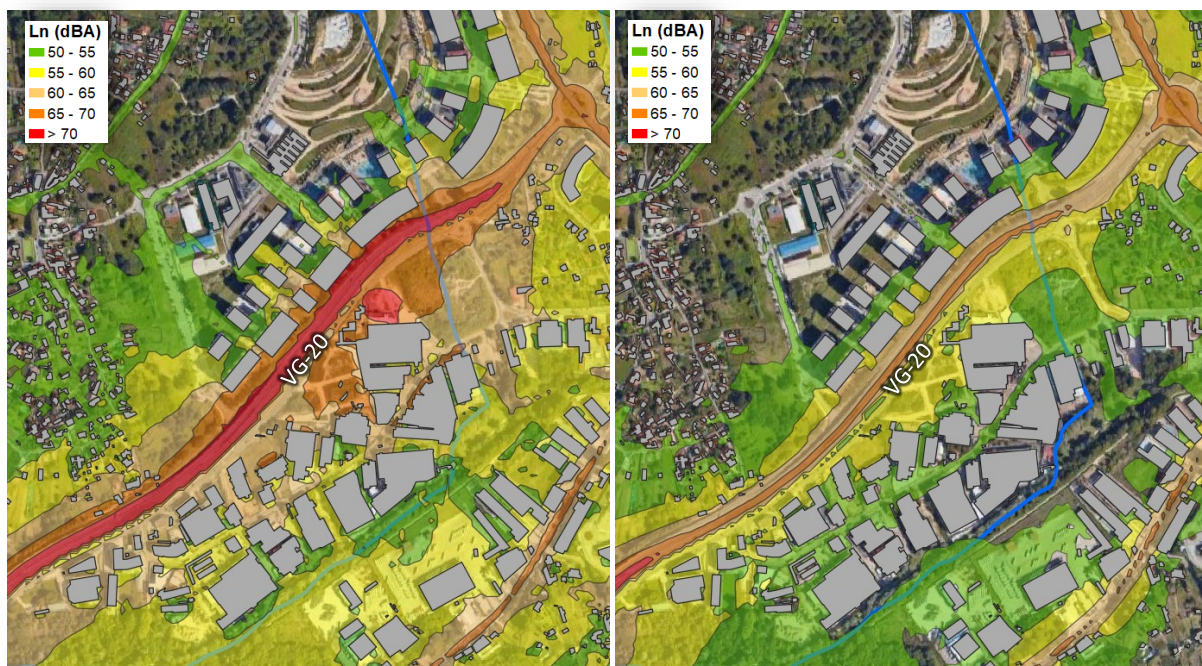
Figura 26. Niveis de ruído global, Ln (dBA), na contorna da VG-20, nos seus dous primeiros quilómetros. Esquerda, situación actual; dereita, tras a redución de velocidade indicada
