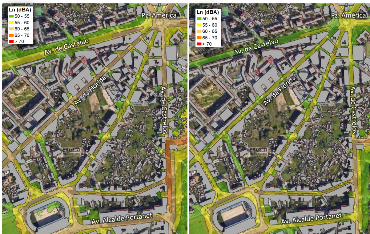
Figura 32. Niveles de ruido nocturno, Ln (dBA), en el entorno de la Avenida de Castelao, Castrelos, Florida y Alcalde Portanet. Izquierda, situación actual; derecha, tras el asfaltado acústico indicado
