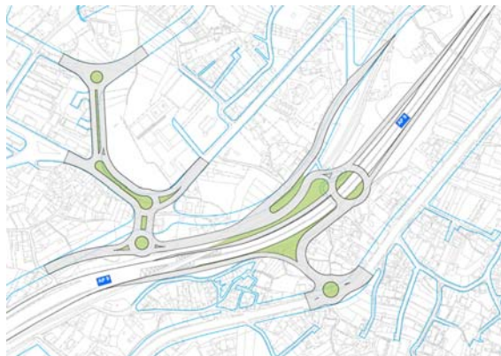
Solución 2: Glorieta central en estructura. Imagen sobre cartografía y PXOM.
