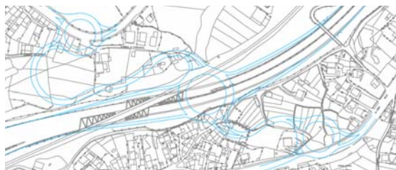
Solución 1.A: Glorieta central en estructura. Pendiente de conexión entre glorieta Norte y central en el entorno del 6%. Pendiente de conexión entre glorieta central y Sur, 8,5%.
