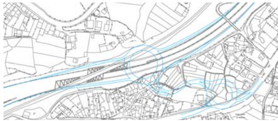
Solución 1.B: Glorieta central en estructura. Pendiente de conexión entre glorieta central y Sur, 8,5%.
